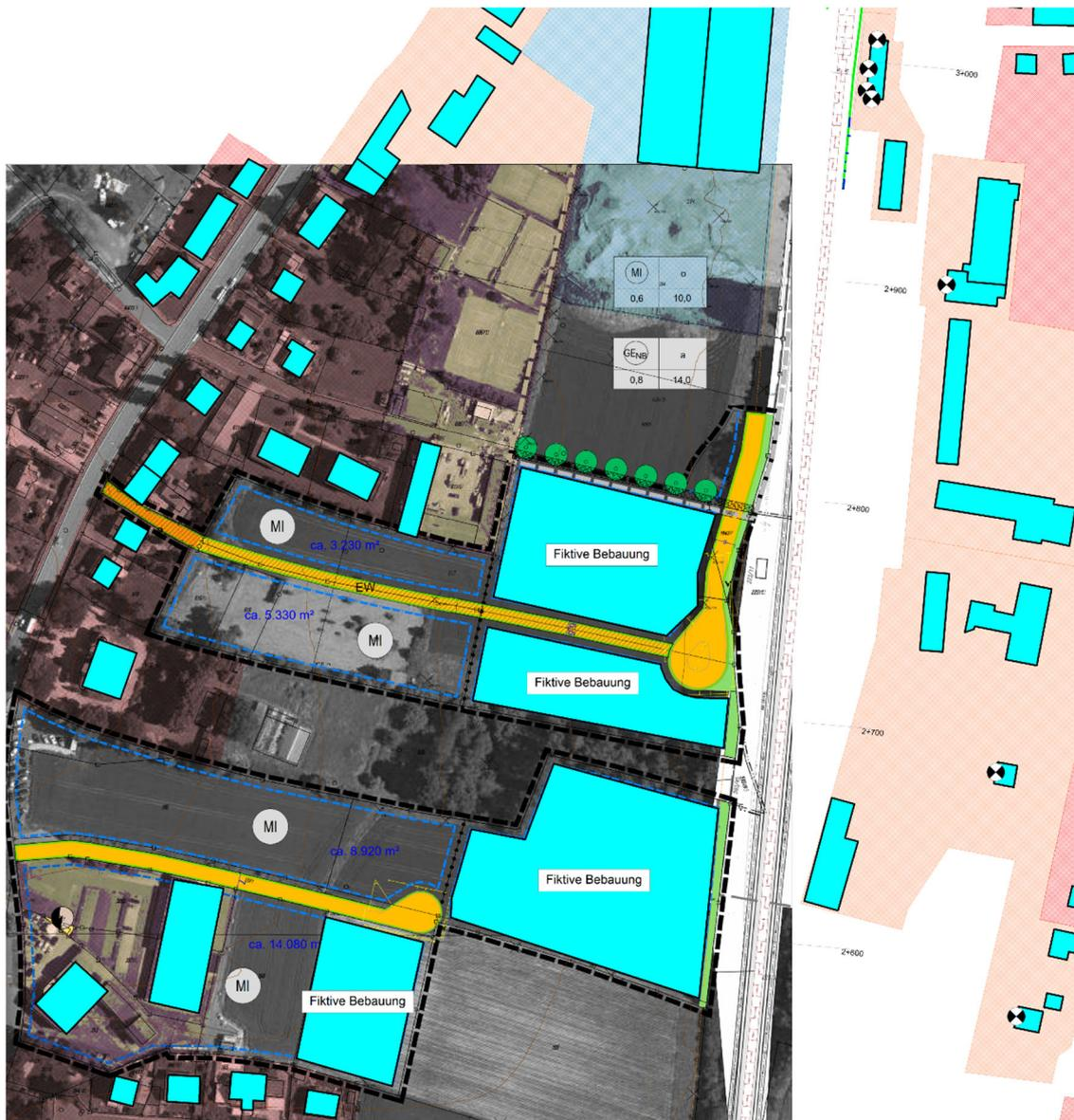
Abbildung 2: Darstellung der fiktiven Bebauung sowie der Berechnungspunkte an den bestehenden Gebäuden östlich der zukünftigen Bundesstraße B 299
